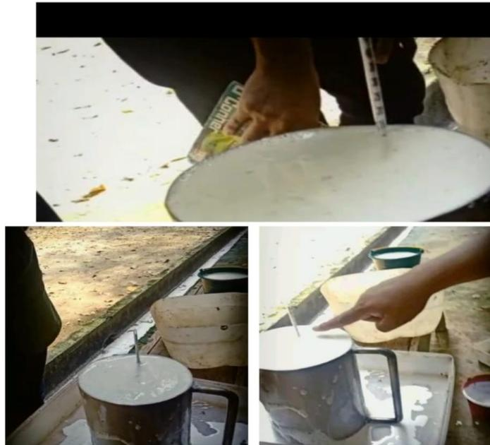
Gambar 2.36 Proses Pengukuran DRC
