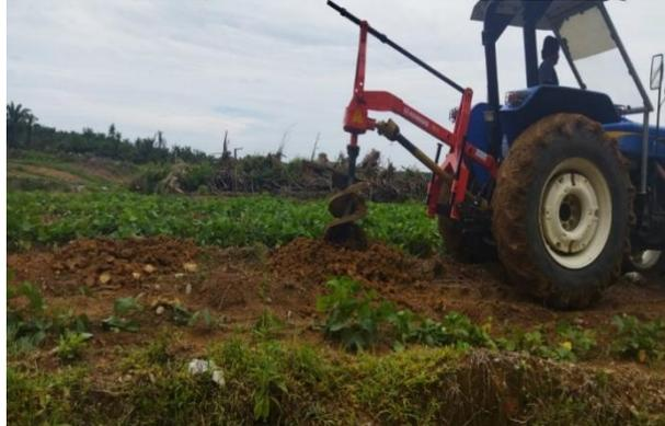
Gambar 2.17. Pembuatan Lubang tanam Dengan alat mekanisasi wheel traktor hole digger
