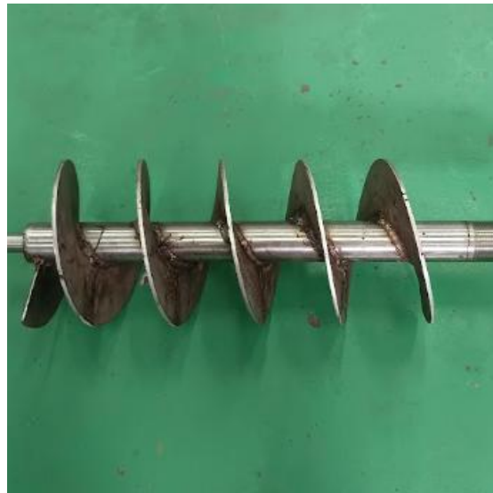
Gambar 32 Manufaktur Screw dan poros
