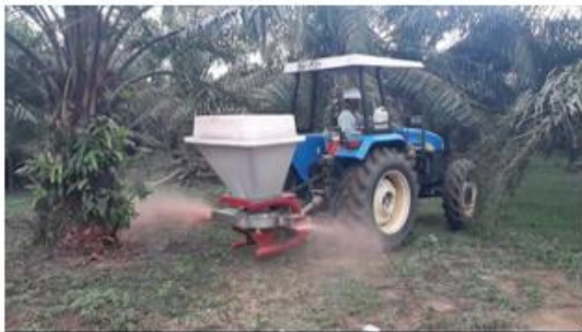
Gambar 2. Penggunaan fertilizer applicator dalam kegiatan pemupukan
