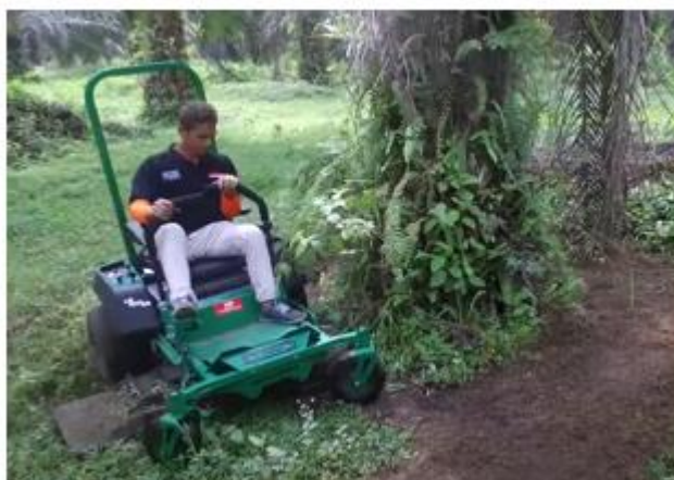
Gambar 4. Penggunaan alat mekanis pengendalian gulma ( land mower )
