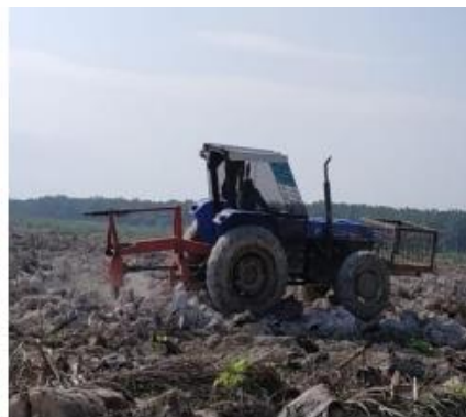
Gambar 9. Pembuatan lubang tanam dengan hole digger
