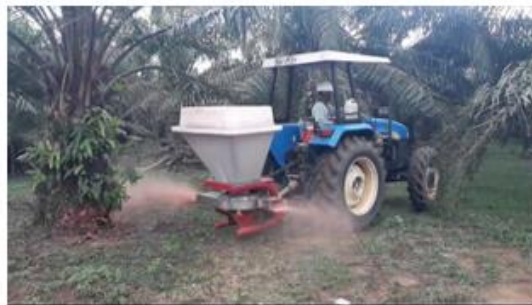
Gambar 2. Penggunaan fertilizer applicator dalam kegiatan pemupukan
