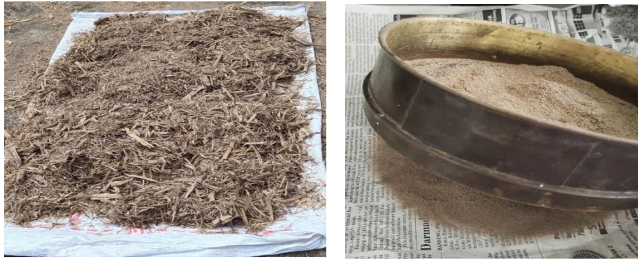
Gambar 4. Penjemuran dan Penyaringan Ampas Tebu
