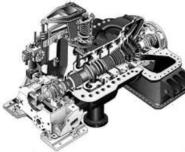
Gambar 3. 10 Bagian Turbin Uap Ekstraksi condensing
