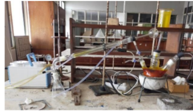
Gambar 3. Labu dan Mantel Pemanas Minyak Sawit
